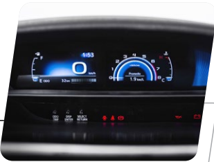
Pantalla multi-información de 4.2" TFT (Thin Film Transistor)
