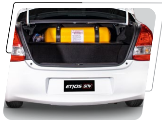
02 Tanques cilíndricos en la maleta de 30 litros c/u
