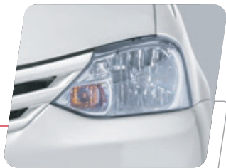
Faros delanteros halógenos tipo multireflector
