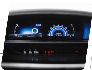
Pantalla multi-información de 4.2" TFT (Thin Film Transistor)
