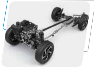
Disposición FR: motor adelante y tracción posterior
