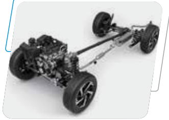
Disposición FR: motor adelante y tracción posterior
