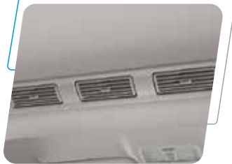
Sistema de ventilación posterior
