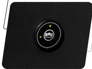
Botón conmutador: Cambia entre GLP o gasolina
